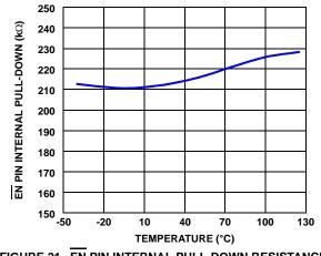
FIGURE 21. EN PIN INTERNAL PULL-DOWN RESISTANCE
